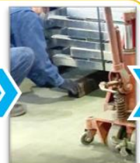
ハンドパレットで上げ、バタ角と差し替え
